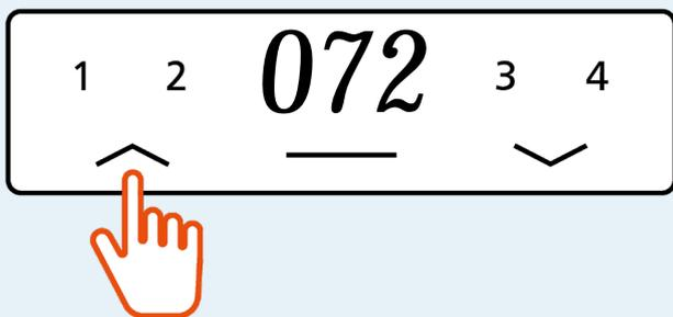
Mit Hilfe der „Auf“- bzw. „Ab“-Tasten den Schreibtisch in die gewünschte Höhe bringen, die Höhe wird auf dem Display angezeigt.
