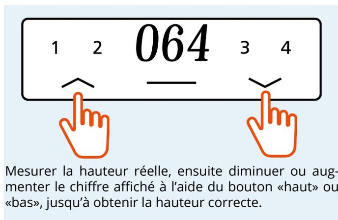
Mesurer la hauteur réelle, ensuite diminuer ou augmenter le chiffre affiché à l'aide du bouton «haut» ou «bas», jusqu'à obtenir la hauteur correcte.
