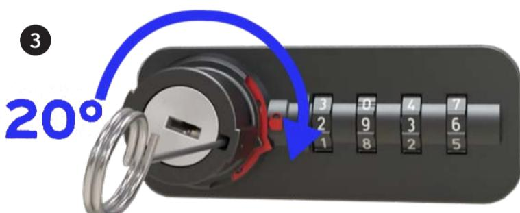
Mit heruntergedrücktem Codierpin den Knopf auf ca. 20° verdrehen bis der Pfeil am Drehknopf mittig auf das rote Dreieck am Schlossgehäuse ausgerichtet ist. Es ist ein kleiner Widerstand zu spüren.
