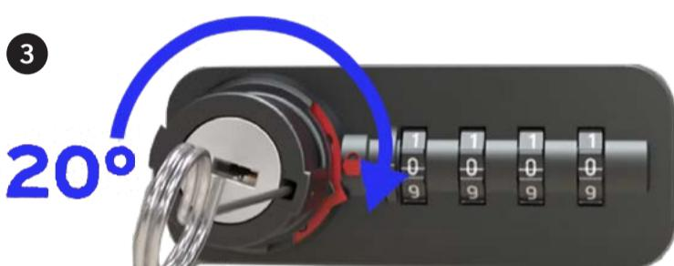
Mit hineingedrücktem Codierpin den Knopf auf ca. 20° verdrehen bis der Pfeil am Drehknopf mittig auf das rote Dreieck am Schlossgehäuse ausgerichtet ist. Es ist ein kleiner Widerstand zu spüren.
